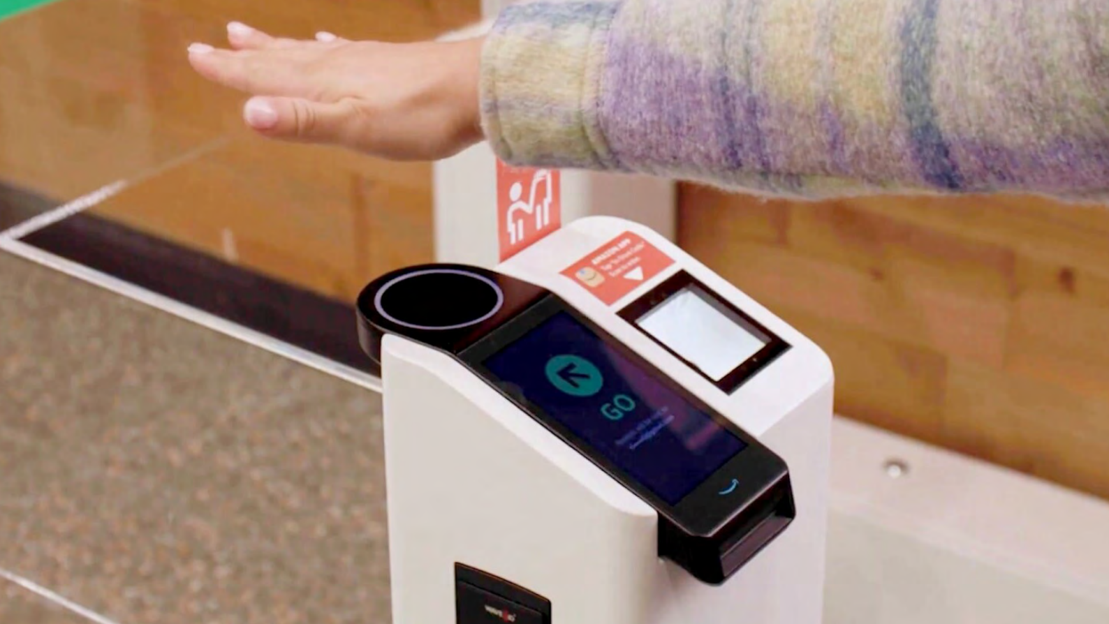
Abb.: Amazon One; berührungslose, einfache Authentifizierung per Scan der Handfläche, Quelle: https://www.aboutamazon.com/news/retail/generative-ai-trains-amazon-one-palm-scanning-technology
